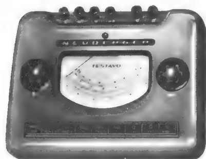
Bild 1. Vielfach-Meßgerät Testavo 1 mit Drucktastensatz zum Wählen der Meßart
